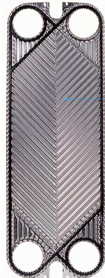
●プレートの汚れは完全に落ち、新しいガスケットの接着も万全。これにより、新品とほとんど同様の性能とガスケット寿命が戻り、安心して運転を再開することができます。
