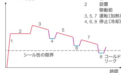
ガスケットは加熱・冷却の繰り返しや経年変化によりゆっくり劣化していきます。
