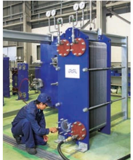
リコンディショニングされたプレートは、最後に「テスト用フレーム」に組み込んで圧力テストを行い、内部漏れ\*1や外部漏れ\*2の無いことを確認した後、お客さまのもとに送られます。「テスト用フレーム」は、さまざまなサイズ・種類のプレートに対応しています。
