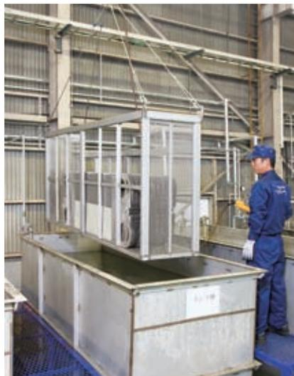
$70^{\circ}\text{C}$ の温度に保たれた洗浄用のアルカリと酸の槽にプレートを浸します。
