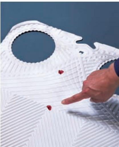
プレートの腐食、クラック、変形などを熟練した専門家の目視により厳密に検査します。また、ご希望によりカラーチェック(浸透探傷試験)をおこない、目に見えない極小ピンホールの有無を調べます。
