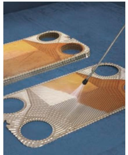
高圧水洗浄によって汚れを完全に落とします。
