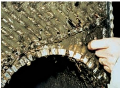
プレート式熱交換器の閉塞により、圧力損失の増大と液漏れが併発しました。
