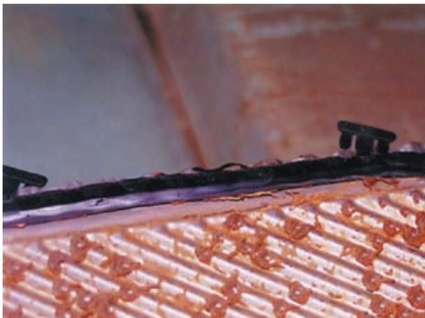
瞬時に起こる圧力変動の繰返しにより、ガasket(クリップオン方式)が外れてしまった例。
