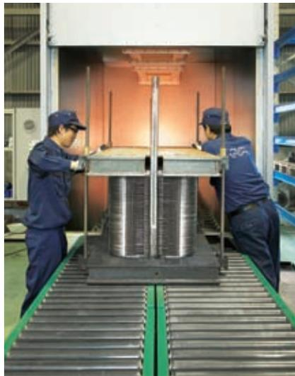
ガスケットを接着したプレートを、締めつけた状態で150°Cの炉に入れ、接着剤を硬化させます。これにより、万全の接着効果が得られます。
