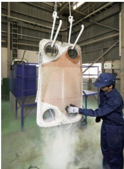
液体窒素（ $-196^{\circ}\text{C}$ ）の入った槽にプレートを浸します。ゴムと金属の低温収縮率の違いにより、古いガスケットを簡単に取り除くことができます。
