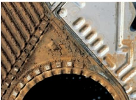
冷却塔の水を使ったプレートに、増殖した微生物と粘土質の浮遊物が見られます。
