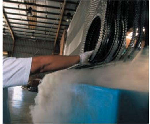
アルファ・ラバルのリコンディショニングは、メーカーならではのノウハウを生かし、専門の設備で、お客様の大切なプレートを傷めることなく、普通に洗浄しただけでは、なかなか落ちない汚れまで完全に落とします。そのため、機器を新品同様の能力に回復することができます。
